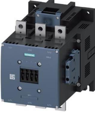
güç kontaktörü, AC-3 400 A, 200 kW / 400 V AC (50-60 Hz) / doğru akım işletimi UC 220-240 V yardımcı kontaklar 2 NA + 2 NK 3 kutuplu, ebat S12 bara bağlantıları tahrik: klasik vida bağlantısı
