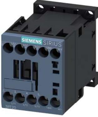
güç kontaktörü, AC-3 12 A, 5,5 kW / 400 V 1 NA, DC 24 V 3 kutuplu, ebat S00 vida bağlantısı
