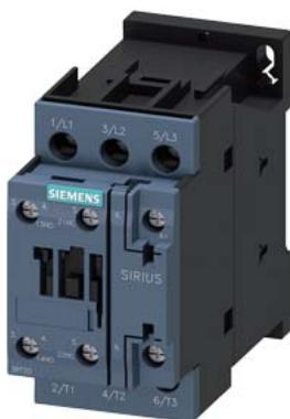
güç kontaktörü, AC-3 25 A, 11 kW / 400 V 1 NA + 1 NK, AC 230 V, 50 Hz,
