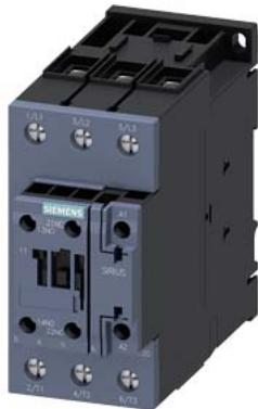
güç kontaktörü, AC-3 80 A, 37 kW / 400 V 1 NA + 1 NK, AC 230 V, 50 Hz 3 kutuplu, ebat S2 vida bağlantısı
